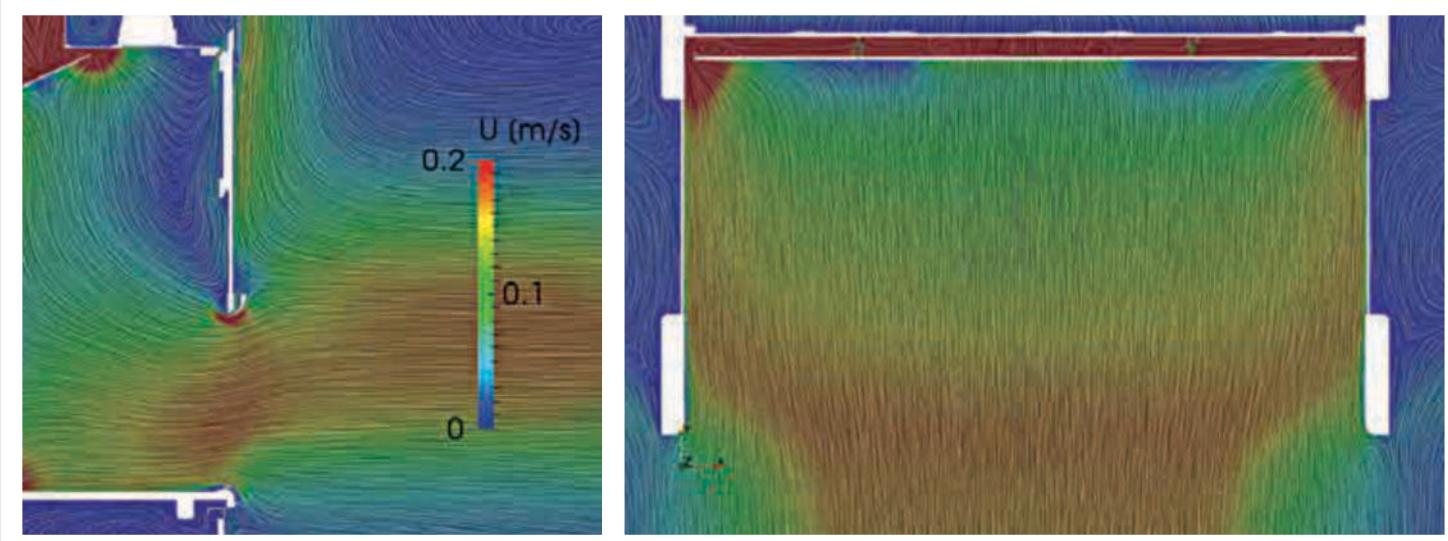
(\*) Portata dell'aria testata e certificata con velocità frontali cappa V1=0.15 m/s, V2=0.30 m/s, V3=0.50 m/s
