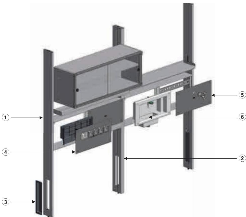
**①** Piantana terminale in alluminio, sezione mm 150x25, con guida per il fissaggio di accessori pensili
